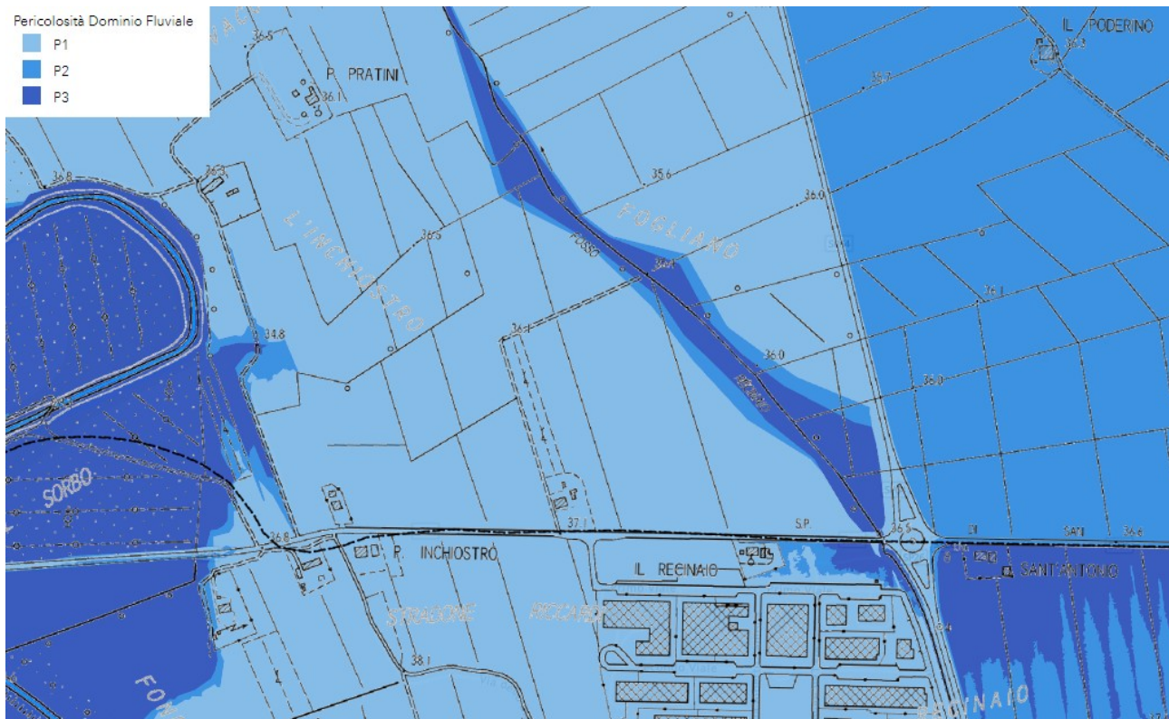
Figura 4.1: pericolosità idraulica PGRA
